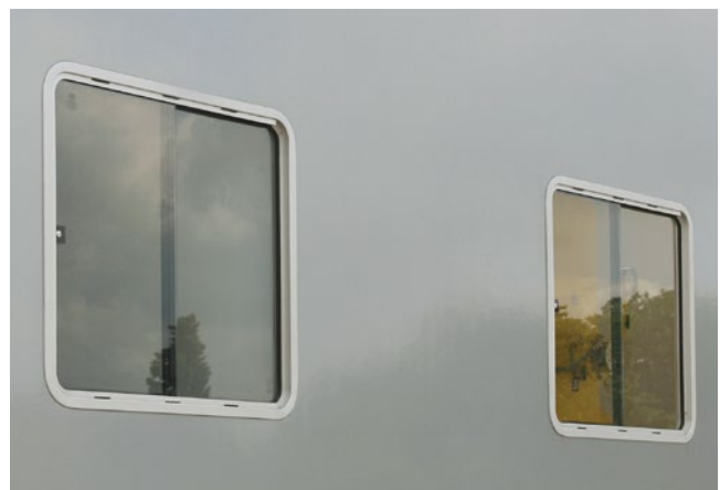
Fenster mit Alurahmen in der Seitenwand montiert
