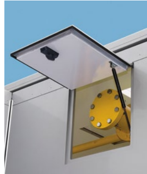
Seitenklappen mit verdeckter Dichtung
