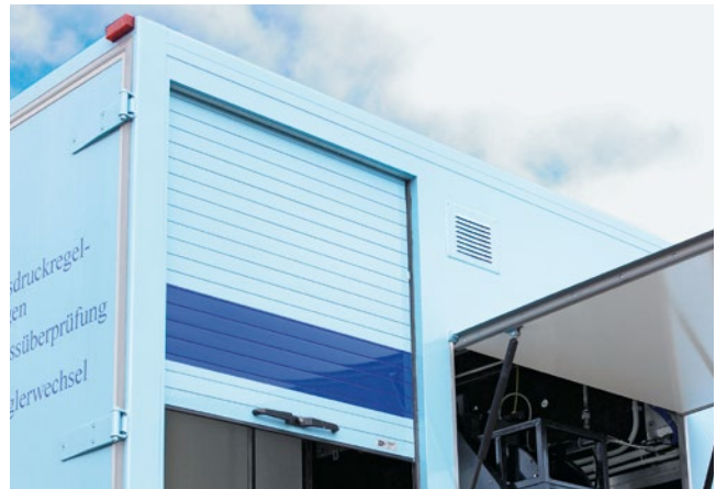
Seitenwand mit Rolläden, Aufstellklappe und Kiemenblech auf engstem Raum vereint.
