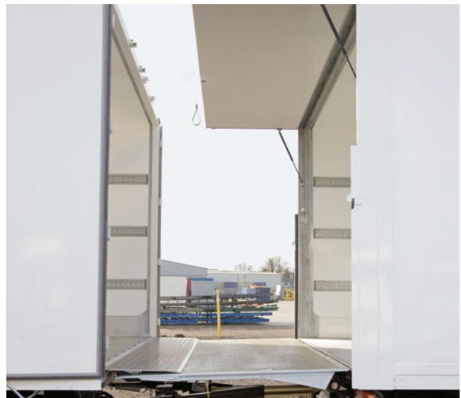
Plastivanaufbau als Durchlader mit montierten Türen und innenliegendem Überfahrblech oder mit Ladebordwand und Oberklappe.
