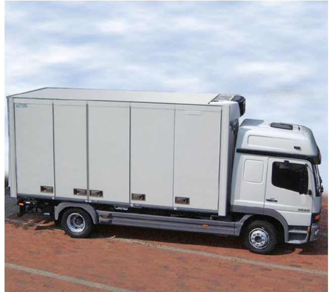
Faltwandanlage für die seitliche Beladung
