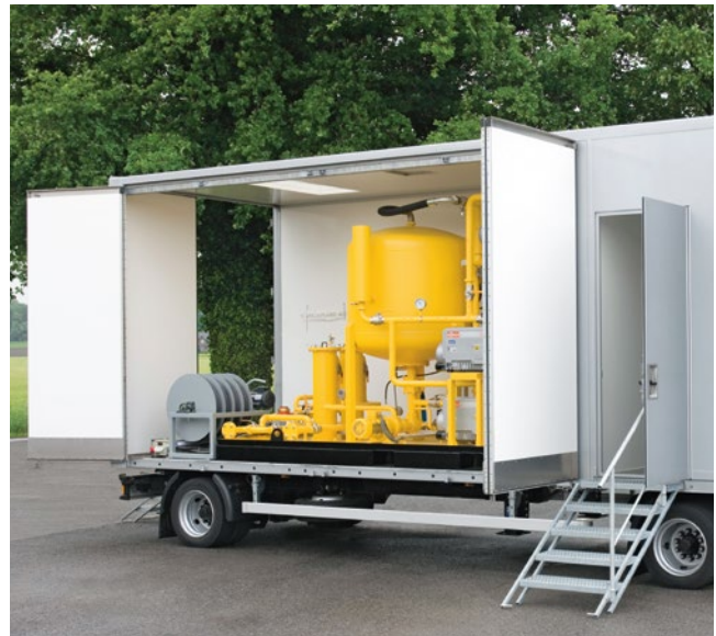
Große Öffnung bei freitragendem Dach
