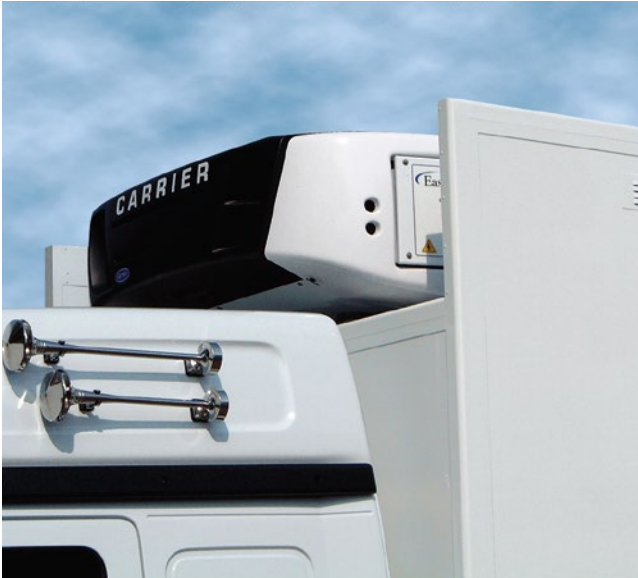
Negativer Dachausschnitt für die Montage einer Kühlanlage
